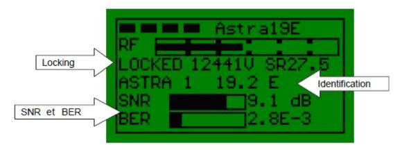
Le SNR et les barres BER seront affichés lorsque le satellite voulu a été trouvé. Le mot "LOCKED" sera également présenté en face de la fréquence. Le NIT (Tableau d'information) sera présenté, si il est transmit comme tel. Signaler un satellite
