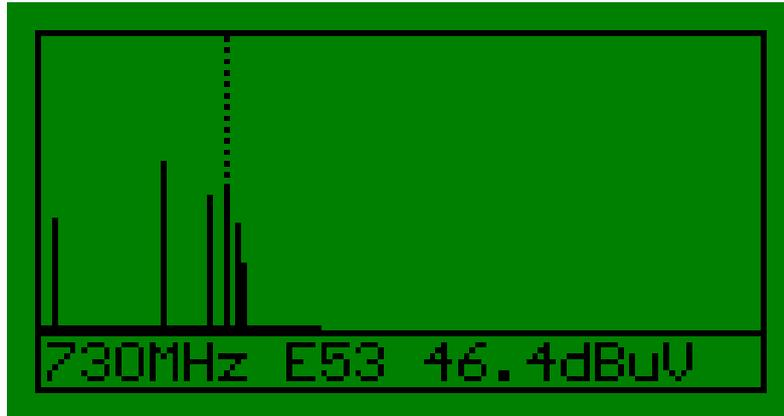
El medidor muestra el espectro de 48-860 MHz. Dispone de un marcador, que puede mover con los botones “UP” y “DOWN”, con el que puede leer el nivel de un canal ( en dBuV )
